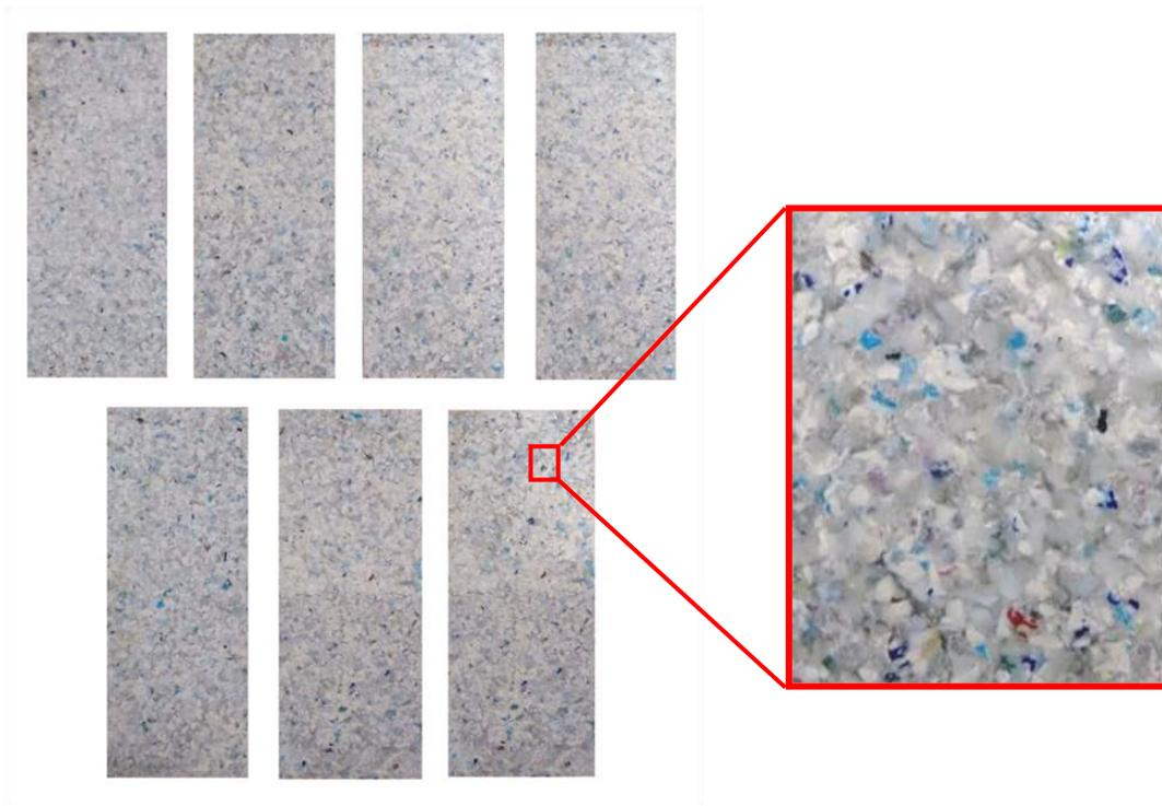
**Figura 25.** Muestras del lote 2 expuesto a 500 h de intemperismo acelerado.
