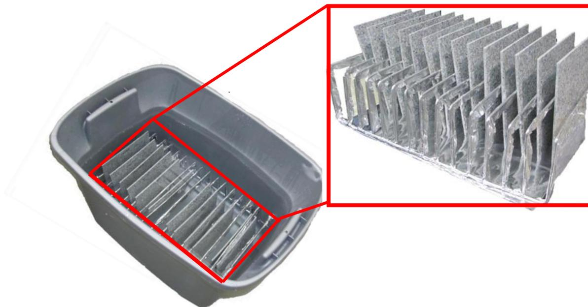
**Figura 19.** *Inmersión de muestras para prueba de absorción de agua.*
