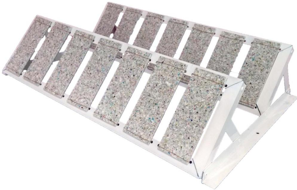
**Figura 21.** Estructura elaborada para exposición de las probetas de flexión a intemperismo natural.
