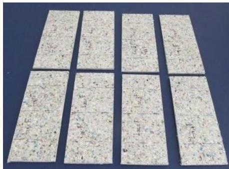
**Figura 15.** *Probetas de flexión.*
