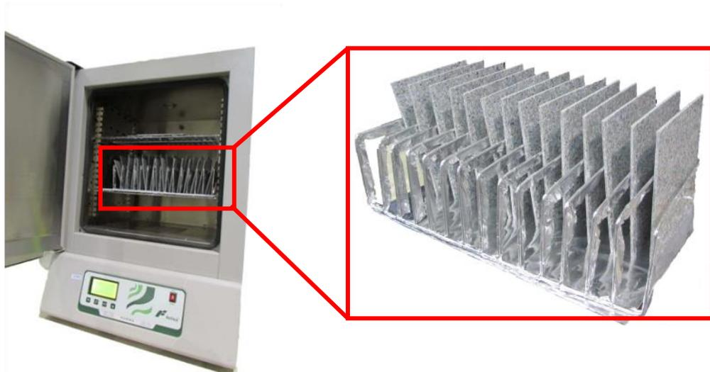
**Figura 18.** *Secado de muestras de absorción de agua.*
