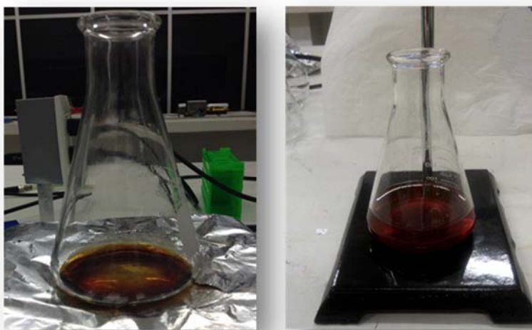
Figura 2.6 Determinación de índice de acidez del ACU.
