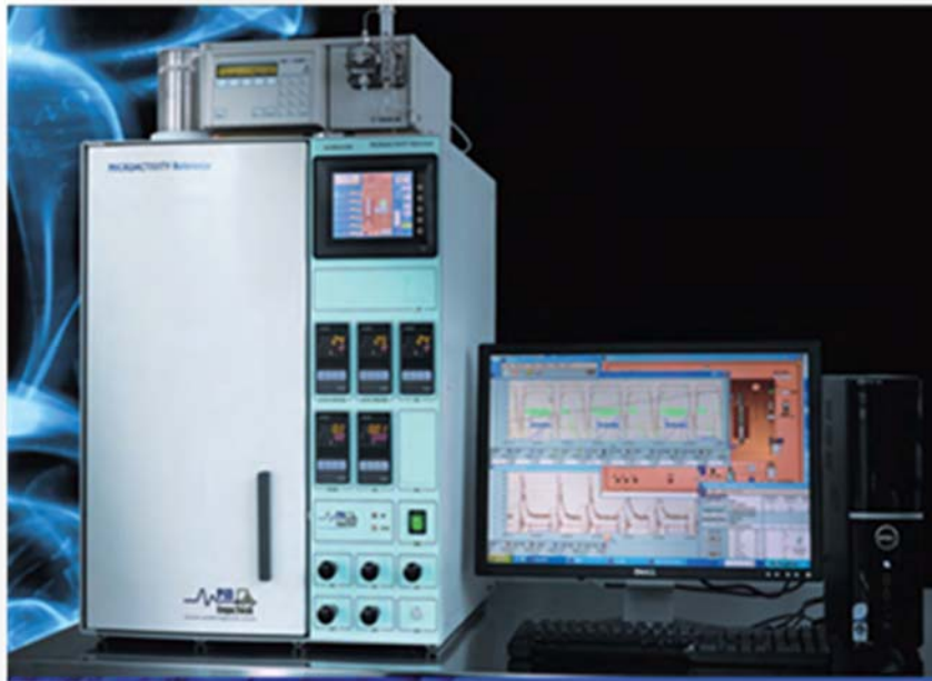
Figura 2.10 Reactor de lecho fijo empleado en la reacción de DO.
