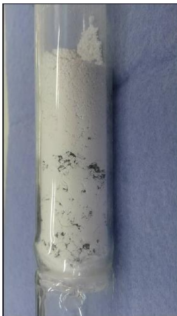
Figura 2. 4 Mezcla de soporte con carburo de silicio para la calcinación
