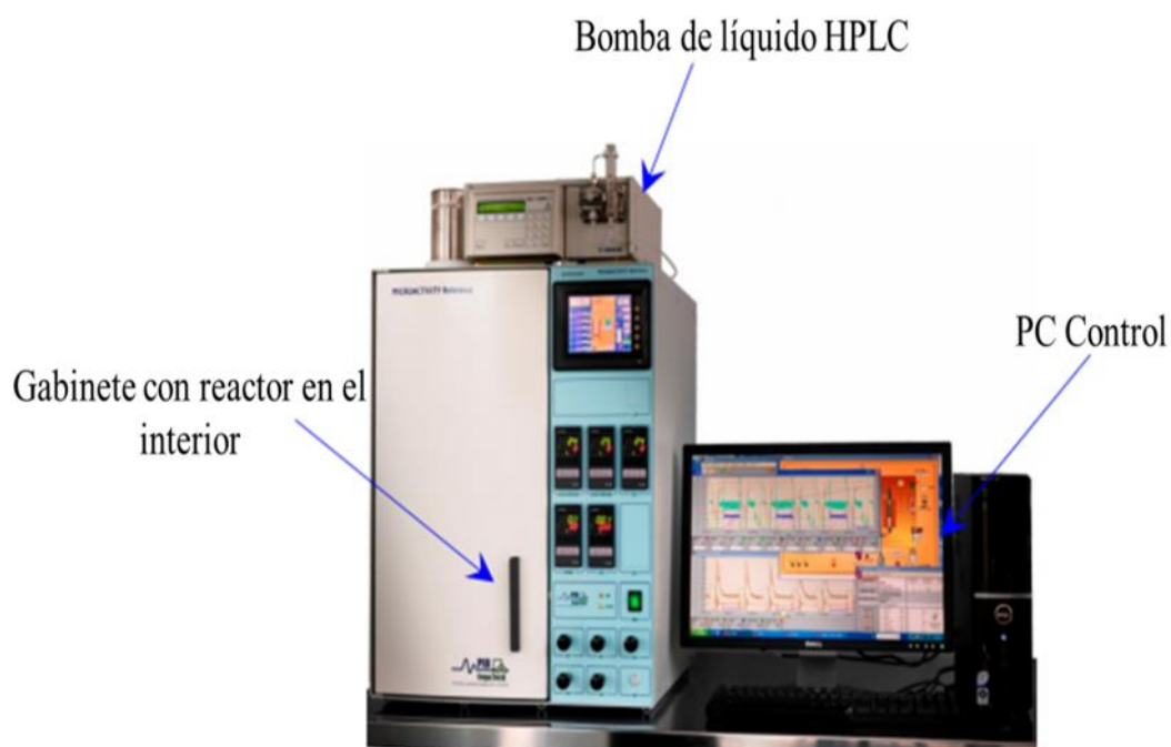
Figura 2. 14 Reactor de lecho fijo para la evaluación del catalizador
