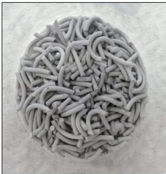
Figura 2. 7 Extruidos de ZSM-22/ \gamma -Al 2 O 3 (HMDA)
