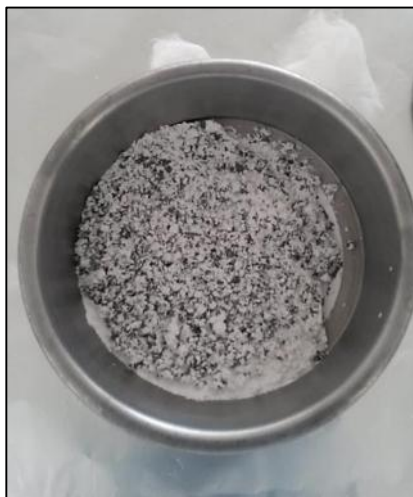
Figura 2. 9 Catalizador siendo tamizado para separarlo del SiC
