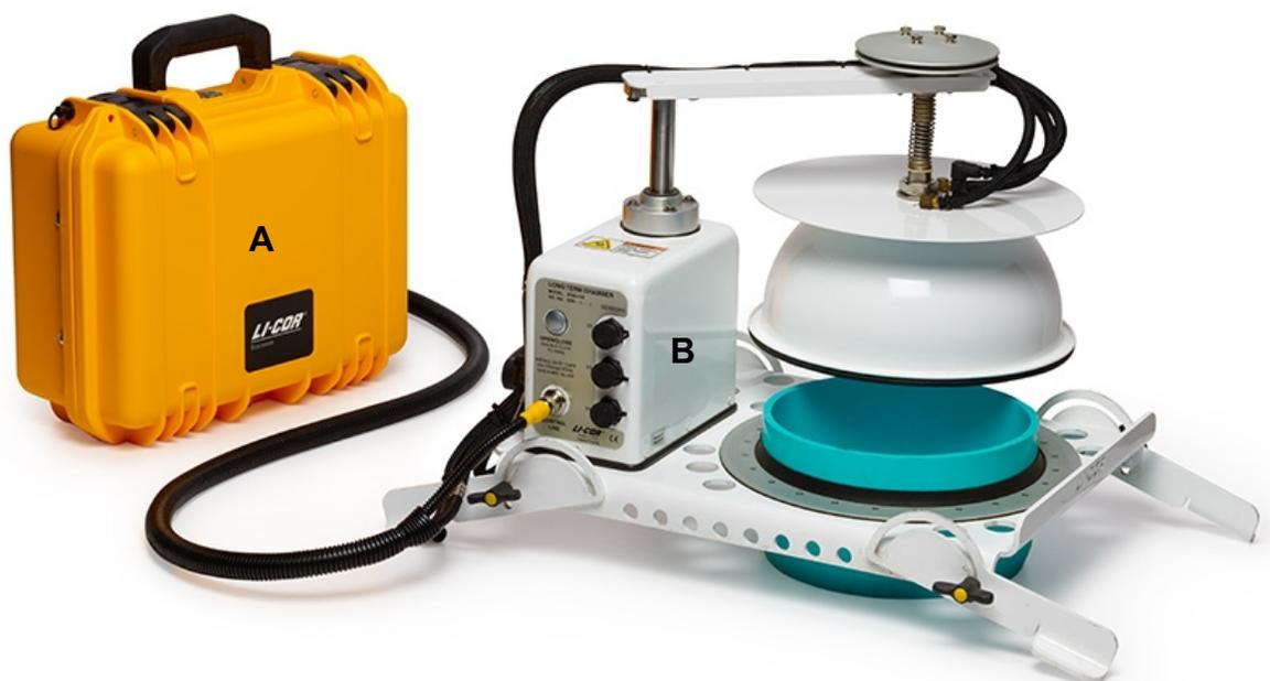
**Figura 3.** Cámara automática de sistema cerrado dinámico (LI-8100A, LI-COR, Lincoln, Nebraska), puede apreciarse la urna que contiene el analizador de gases (A) y la base (B) que contiene un anillo de PVC para delimitar el punto de medición. Cortesía Lucía Miceli.
