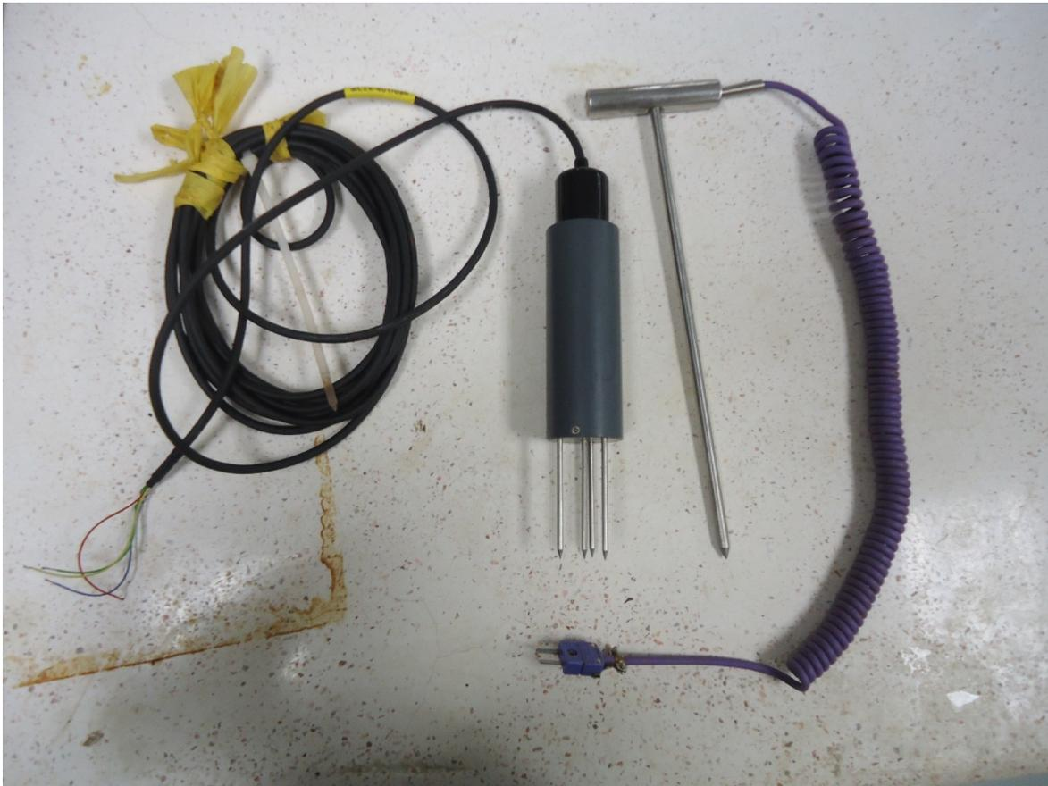
**Figura 9.** Sondas utilizadas para la medición de la humedad en el suelo, como contenido volumétrico de agua en el suelo (izquierda), y la temperatura en el suelo (derecha)
