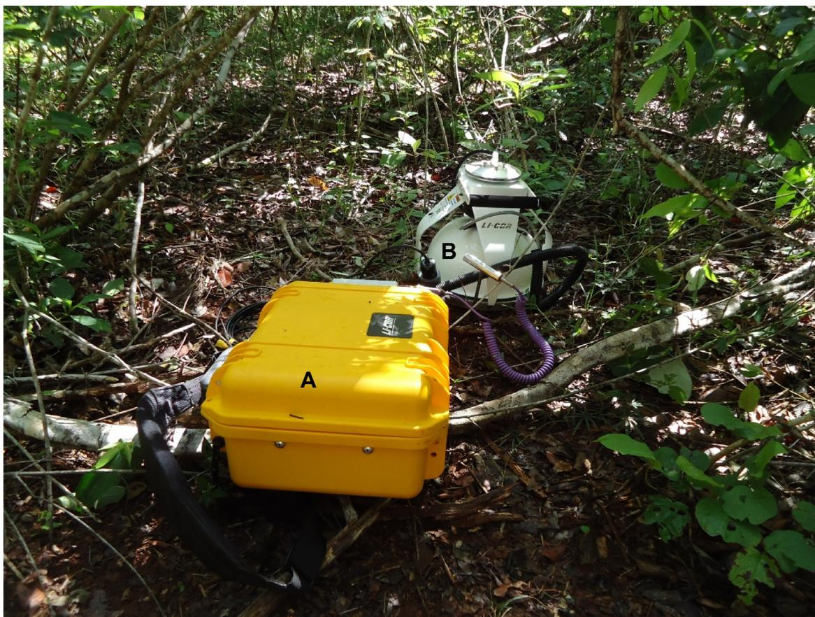
**Figura 2.** LI-8100A (LI-COR, Lincoln, Nebraska), un sistema comercial de cámara manual cerrada dinámica. Puede apreciarse la urna que contiene el analizador de gases (A) al que se conecta la cámara (B).
