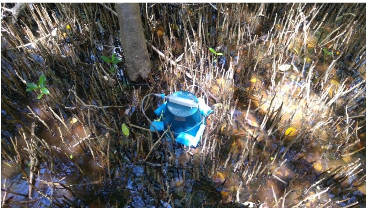
**Figura 1.** Cámara de sistema cerrado estático para la medición de emisiones de gases de efecto invernadero en el suelo de un manglar mediante el método del cromatógrafo. Nótese que la cámara fue elaborada a partir de una cubeta. Cortesía Rodrigo González Valencia.
