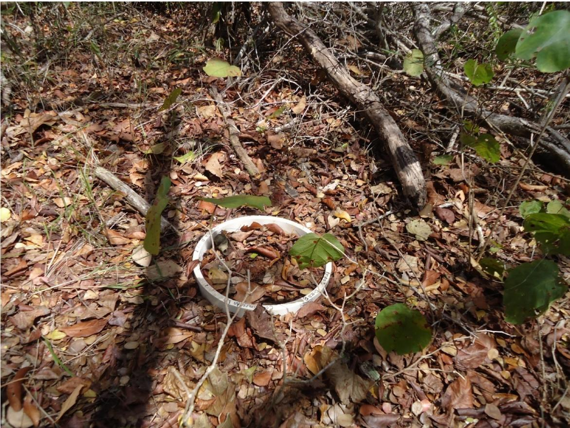
**Figura 8.** Anillo de PVC insertado en uno de los sitios de muestreo, instalado un mes previo a las mediciones del flujo de CO<sub>2</sub> del suelo
