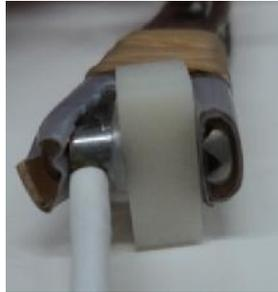
Figura 2.5. Imagen de la fijación del sensor sobre la superficie del espécimen para la prueba de compresión cuasiestática.
