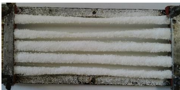
Fig. 4.2. Preformas de materiales compuestos FT/PP.
