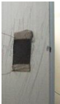
Fig. 1.2. Película polimérica modificada con MWCNT cementada en un espécimen de aluminio para el sensado de deformación [37].
