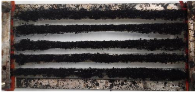
Fig. 4.6. Preformas de materiales compuestos FT-CNT/MWCNT/PP.
