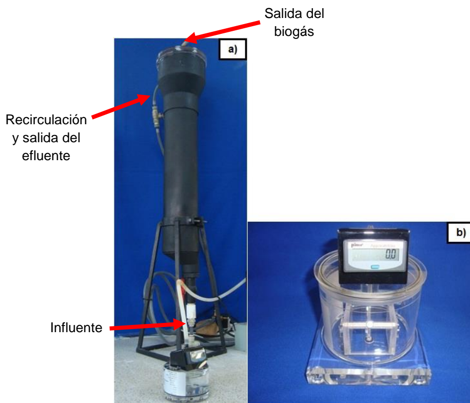
Figura 2.4. Equipos empleados durante la digestión anaerobia de las vinazas de etanol hidratado: a) Reactor Anaerobio de Manto de Lodos, b) Milligascounter®
