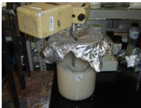
Figura 3.2. Dispersión de la paligorskita en agua destilada.
