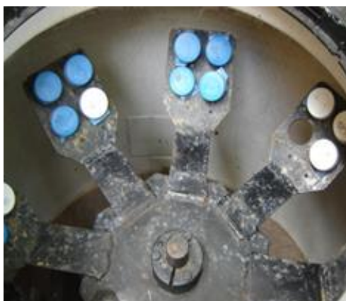
Figura 3.4. Centrifugado de la paligorskita después del tratamiento ácido.
