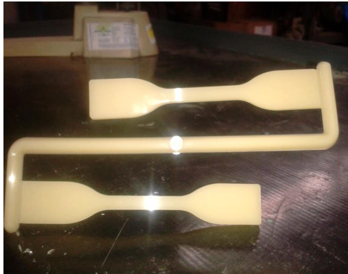
Figura 3.11. Probetas tipo IV de Nylon 6 obtenidas por moldeo por inyección.
