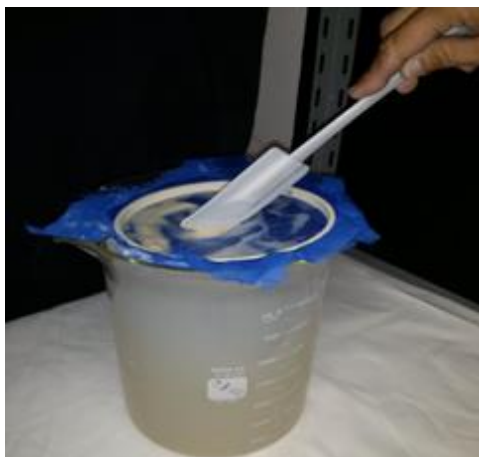
Figura 3.3. Filtrado de la mezcla de arcilla.
