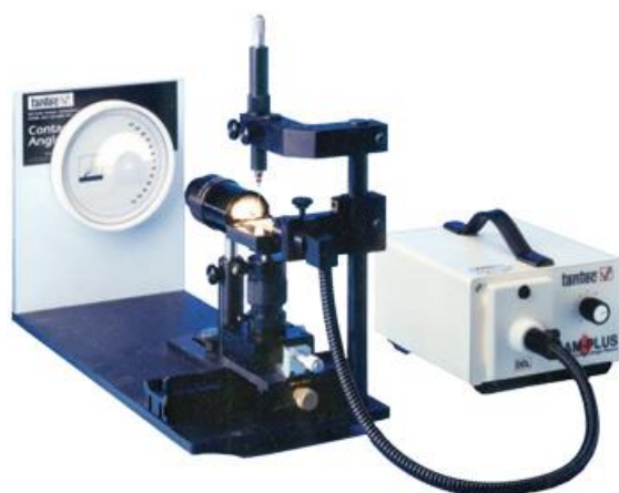
Figura 2.3 Goniómetro para la medición del ángulo de contacto.
