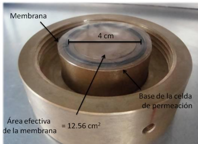
Figura 2.5. Configuración de la celda de permeación.
