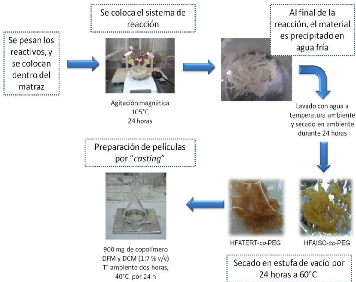
Figura 2.2 Síntesis de las copolietéramidas.
