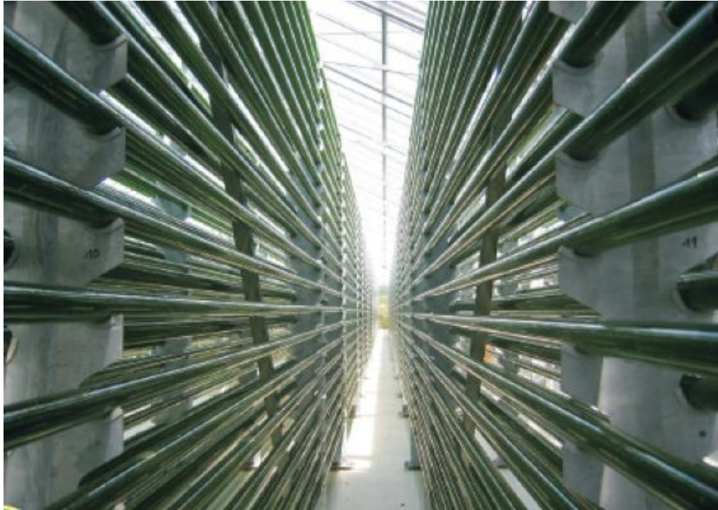
Figura 1.3. Producción de biomasa de microalgas basado en fotobiorreactores tubulares. Imagen de la industria Klötze, en Alemania [61].
