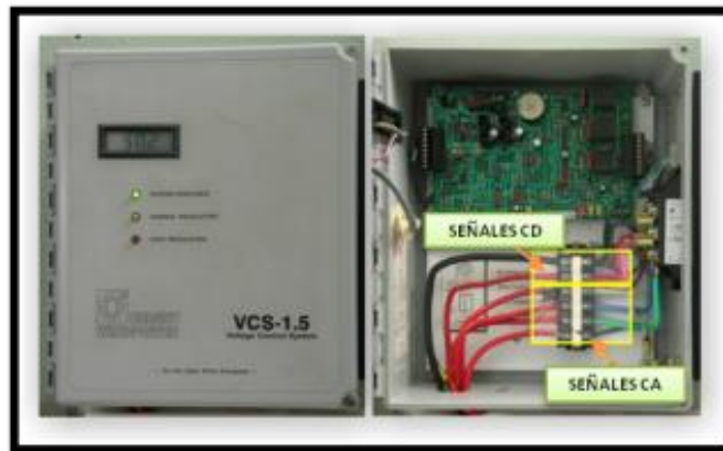
Figura 2.12. Rectificador o Sistema de Control de Voltaje (VCS) del aerogenerador Bergey BWC-1500.
