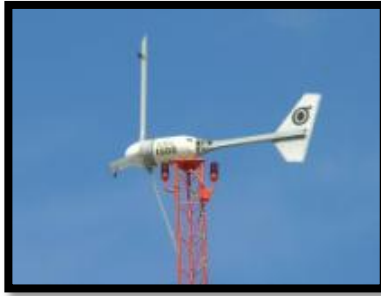
Figura 2.2. Aerogenerador BWC- 1500 del Laboratorio de Energía de la Facultad de Ingeniería de la Universidad Autónoma de Yucatán.
