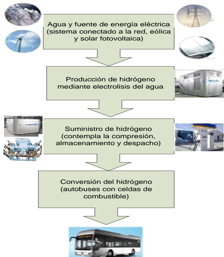
Figura 3.1. Diagrama de bloques de los componentes propuestos en el proyecto producción-suministro-conversión del H 2 en el STPU de la ZMM.
