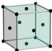
**Figura 1.4 Estructura fcc del níquel**
