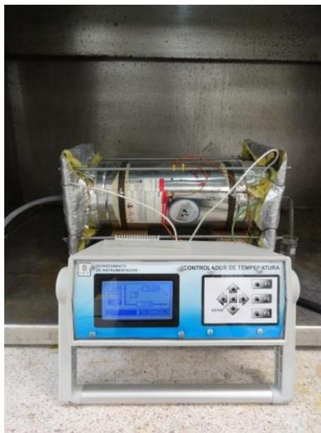
**Figura 2.4 Reactor tubular y sistema de control para el tratamiento térmico de las muestras.**
