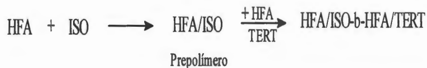
Figura A-1 Método de un prepolímero para copolimerización en bloques.
