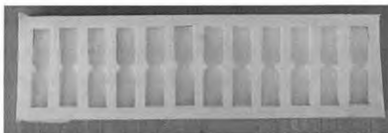
Figura 3.3. Molde de silicón para elaborar probetas de cemento.
