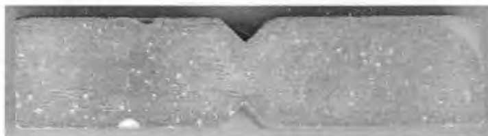
Figura 3.1. Probeta de pasta de cemento para prueba de cortante según ASTM D 5379 [59].
