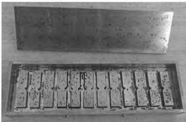
Figura 3.2. Molde de metal para elaborar moldes de silicón.
