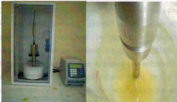
Fig. 3.1 Sonificación de la mezcla
