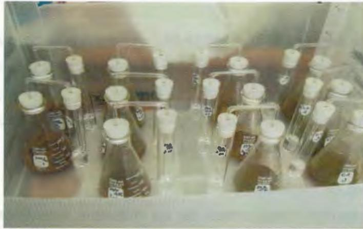
**Fig. 4.1 Sistema de matraces biométricos y KOH 0.5N (solución atrapante de CO<sub>2</sub>)**
