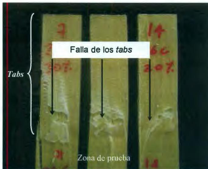
Figura 3.5 Falla de los tabs en las probetas de 24 capas.
