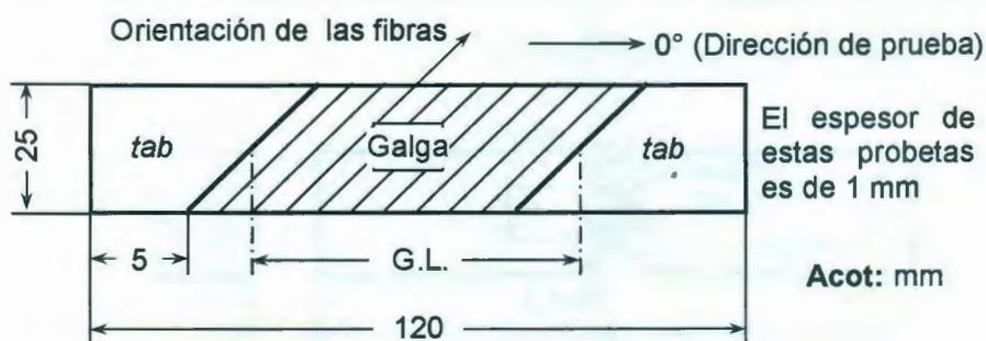
Figura 2.6 Geometría de las probetas para pruebas a tensión.
