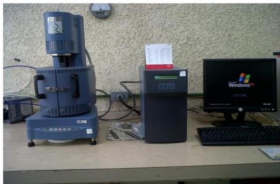
Figura 2. 7. Reómetro AR 2000
