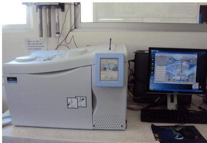
Figura 2. 9. Cromatógrafo de gases
