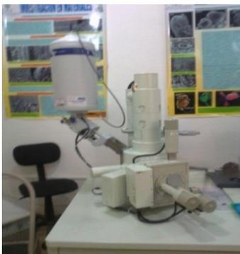
Figura 2. 8. Microscopio electrónico de barrido (MEB).
