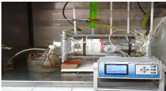
Figura 2.4. Reactor de pirolisis con el controlador de temperatura.
