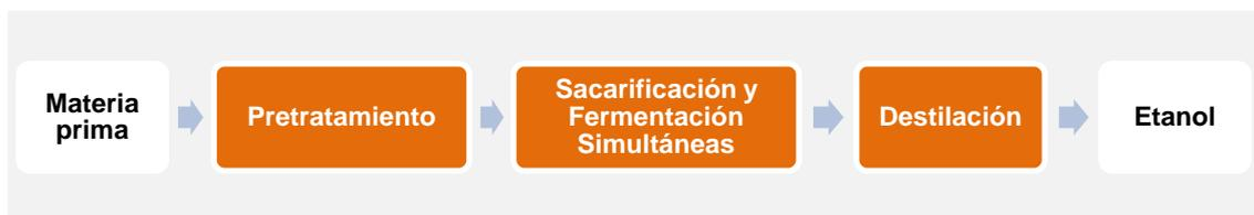
Figura 19. Esquema del proceso de producción de etanol lignocelulósico utilizando la técnica de sacarificación y fermentación simultáneas.
