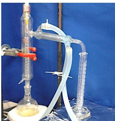
Figura 22. Microdestilación del mosto fermentado de bagazo de sorgo dulce.
