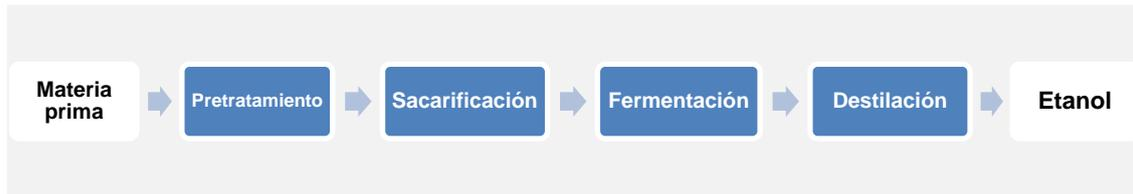
Figura 18. Fases en la producción de etanol lignocelulósico por etapas separadas.
