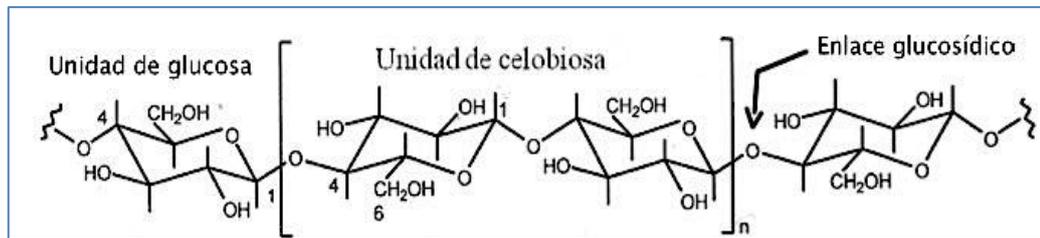
Figura 7. Estructura de las cadenas de celulosa. Se observa la unión de moléculas de glucosa por medio de un enlace glucosídico formando cellobiosa [53].
