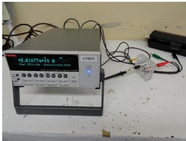
Figura 2.13. Electrómetro de alta resistencia conectado al dispositivo con la muestra.
