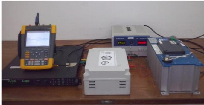
*Figura 3.7: Prototipo del convertidor cd-cd bidireccional flyback.*
