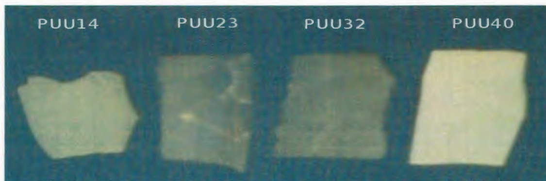
Figura 3.2 En la figura se muestran trozos de las películas obtenidas por evaporación de DMF de los 4 PUU.
