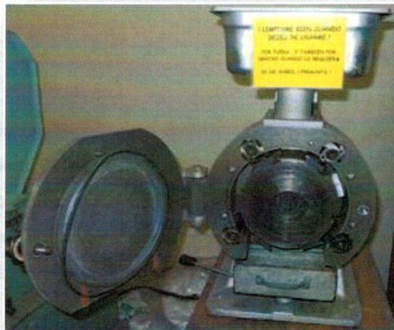
**Figura 2.5** Molino Brabender modelo TI 880804.
