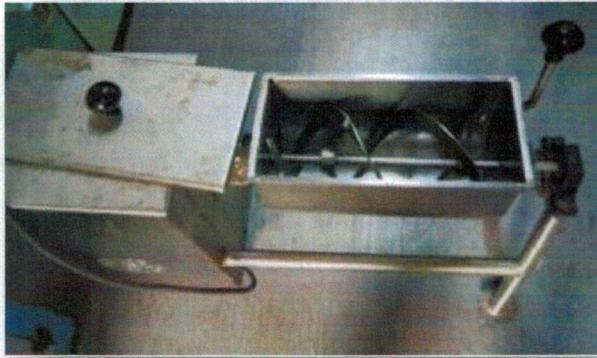
**Figura 2.7** Mezcladora de Cintas (Intertécnica Co.) modelo ML-5.
