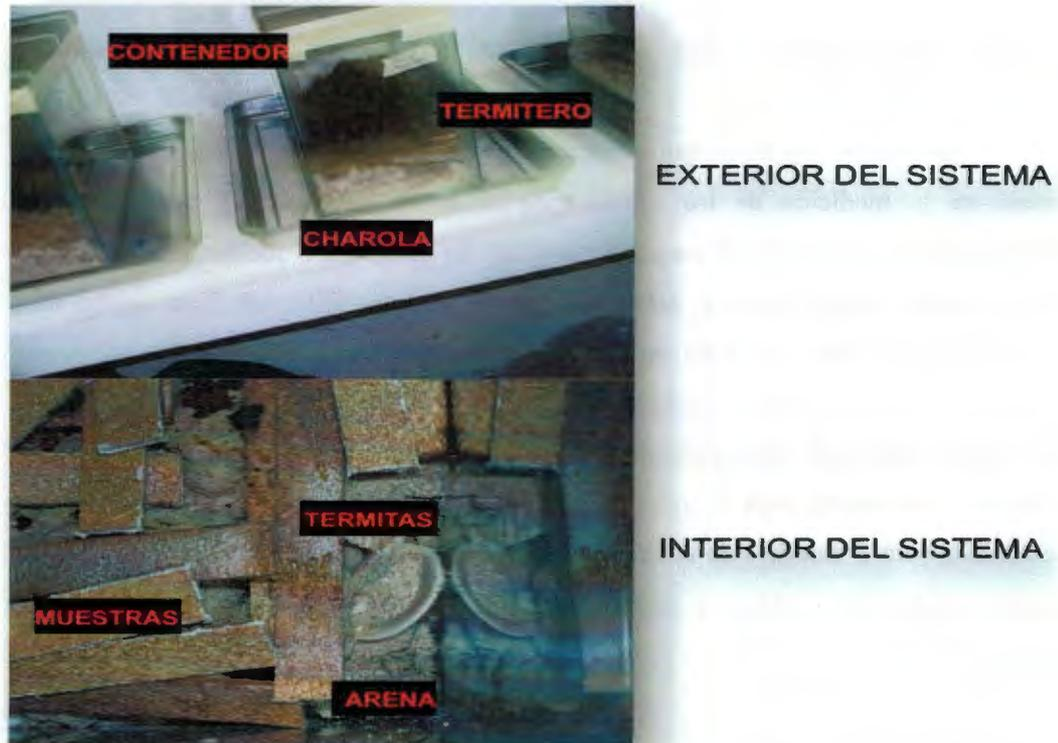
**Figura 2.17** Exposición del material compuesto a degradación biótica.
