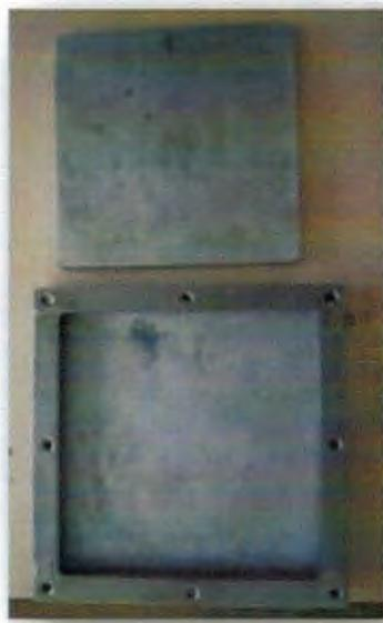
**Figura 2.14** Molde para elaborar placas de material compuesto.
