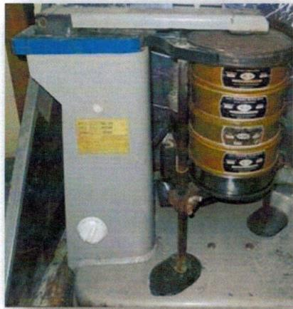
**Figura 2.6** Tamizador marca Rotap (W.S. Tyler, Incorporated) modelo RX-29.
