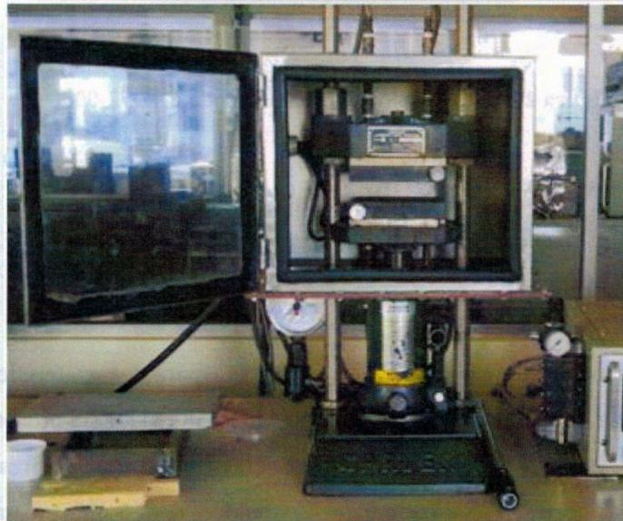
**Figura 2.12** Prensa Carver Manual con gabinete (Carver Lab Press) modelo C serie 29000-035.
