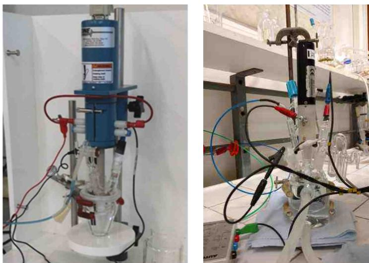
**Figura 17.** Celdas electroquímicas de tres electrodos.
