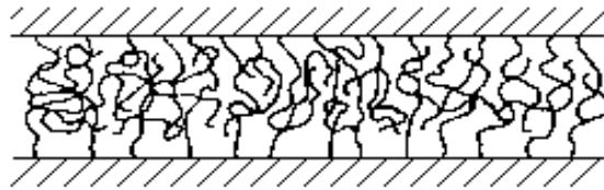
Figura 1.8. Unión entre moléculas por Interdifusión.
