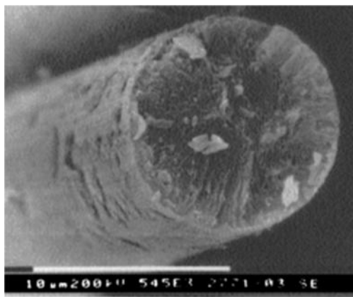
Figura 1.3. Imagen de fibra de carbono, obtenida por microscopía electrónica de barrido.
