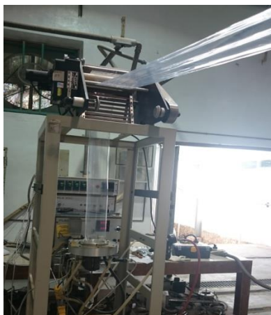
Figura 3.10 Extrusión soplo de las películas de PEBD
