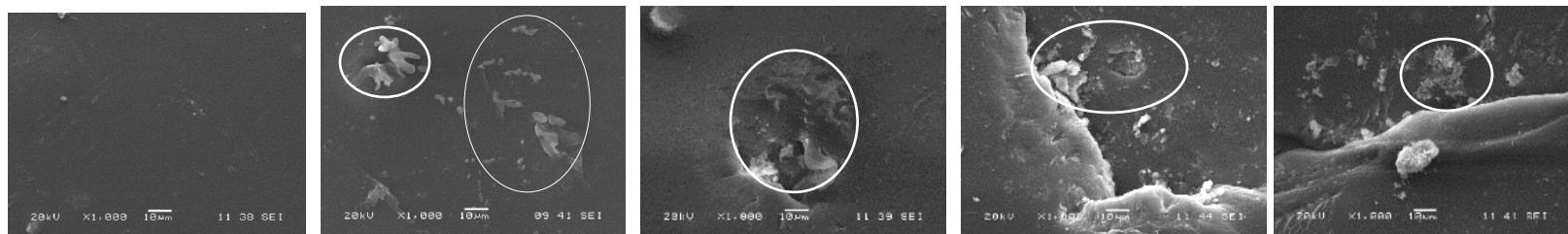
Figura 3.32 Micrografías de los materiales compuestos de PEBD/NCC y PEBD/NCC-g-C 18 a distintos tiempos de composteo
