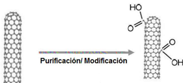
Figura 1.3 Generación de grupos funcionales durante la purificación química de los nanotubos de carbono.
