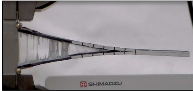
Figura 3.6. Probeta siendo ensayada en la prueba DCB.
