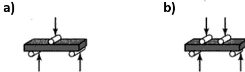
Figura 1.6 Dos métodos de ensayo de flexión de materiales a) flexión en tres puntos y b) flexión en cuatro puntos [59].
