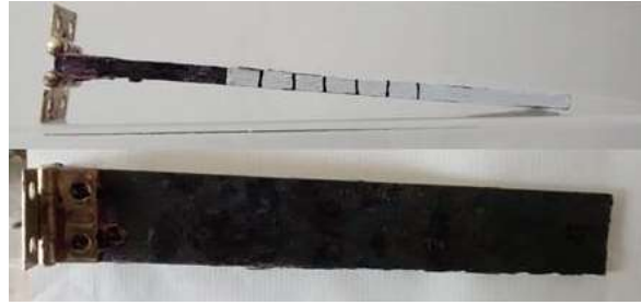
Figura 2.12 Probeta para la prueba de fractura DCB.
