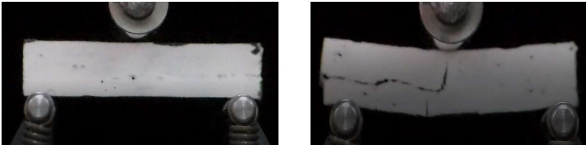
Figura 3.8 Probeta siendo ensayada en la prueba de viga corta.
