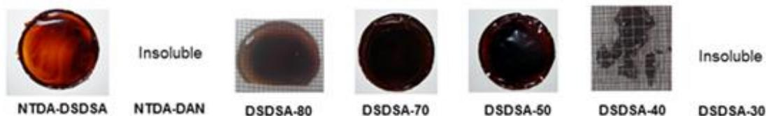
**Figura 12.** Películas densas de poliimididas y copoliimididas sulfonadas que incorporan unidades naftaleno
